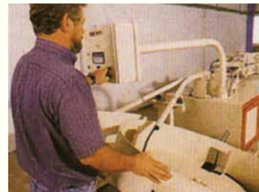
خط تولید نوین تاندون غیرچسبنده با روکش پلی اتیلنی گریس کاری شده به روش Extrusion (کارخانه PBL)
